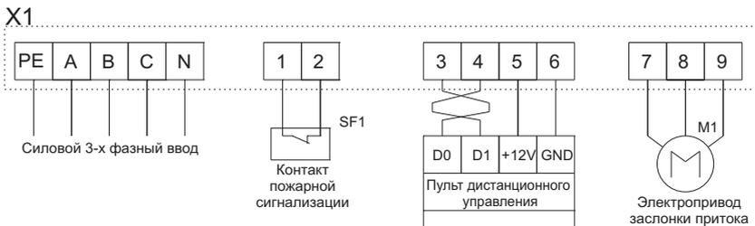
Схема подключения компактной приточной установки VKJet с электрокалорифером (12 кВт).
