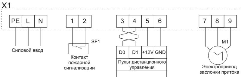
Схема подключения компактной приточной установки VKJet с электрокалорифером (6 кВт).
