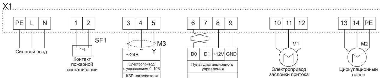
Схема подключения компактной приточной установки VKJet с водяным калорифером.
